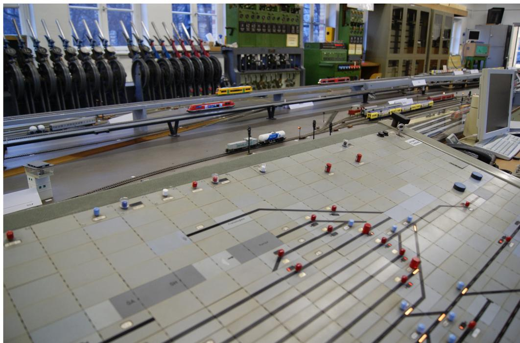
Abbildung 5: Das Stellwerk und (teilweise verdeckt) die Gleise des Bahnhofs Derau. Links im Hintergrund die Stellhebel und Anzeige eines anderen Stellwerks älterer Bauart. Am rechten Bildrand ist der zugehörige Arbeitstisch zu sehen, auf dem dortigen Monitor soll später das ZWL-Bild angezeigt werden. (Quelle: EBUef e.V.)
